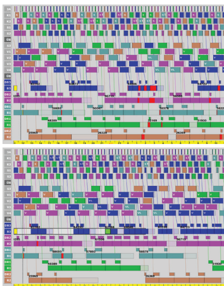
График производства, созданный вручную (вверху) и оптимизированный автоматически с помощью генетических алгоритмов в MATLAB (внизу). В оптимизированном графике минимизированы конфликты расписания (выделены красным цветом), учтены даты поставок и достигнут заданный коэффициент загрузки производственных мощностей.
