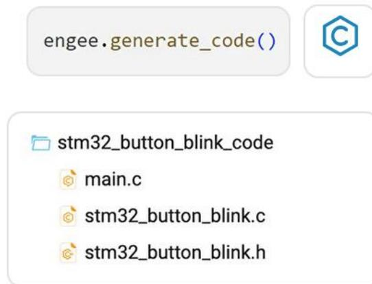
Быстрый, компактный, человекочитаемый, переносимый, независимый от Engage, С-код, трассируемый к модели, можно встраивать в стороннее пользовательское ПО и среды разработки, а также запускать на микроконтроллерах и встраиваемых процессорах.
