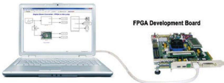
Рис. 10. Симуляция в режиме FPGA-in-the-loop с помощью Simulink и платы с ПЛИС.
