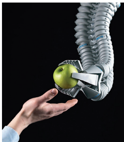
Манипулятор «Bionic Handling Assistant» Изображение © Festo AG.
