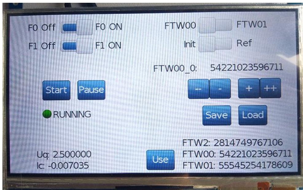
Рис. 7. Разработанный графический интерфейс для управления алгоритмом непосредственно на NeuroMatrix с помощью сенсорной панели
